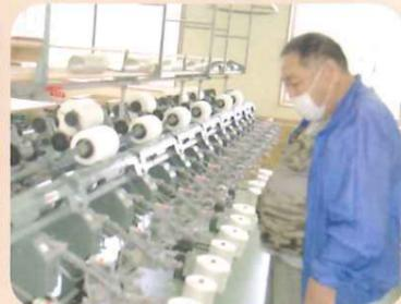
【糸巻き作業】染める前の資材用の糸を専用機械で巻き直す作業をします。
