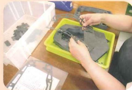
【ガasket型抜き作業】ガasketの型抜きを行い、決められた数に結束し、梱包します。
